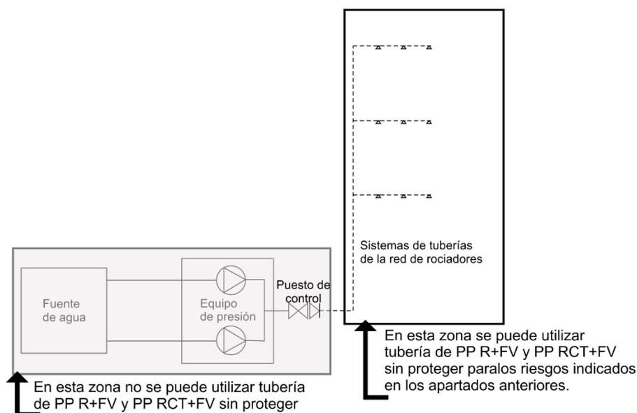
Las limitaciones de uso en instalaciones de BIEs, los sistemas de canalización en polipropileno o polipropileno random con estructura cristalina modificada y fibra de vidrio para instalaciones contraincendios en sistemas de rociadores solo son aptos para su uso en instalaciones vistas, así como espacios ocultos (patinillos, falsos techos, etc.) e instalaciones empotradas aguas arriba del grupo de presión como se indica en el esquema adjunto.
